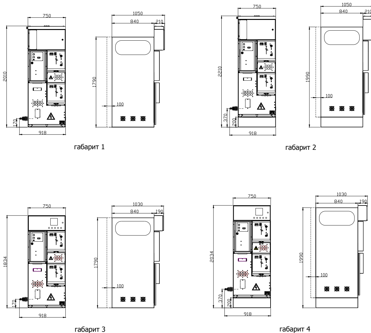
Рис. 1. Габаритные размеры КСО с шириной корпуса 750 мм (схемы №№ 1.1, 1.2, 10, 10.1, 11.1, 11.2, 11.3, 11.4, 14, 19, 20, 21, 22, 33).
