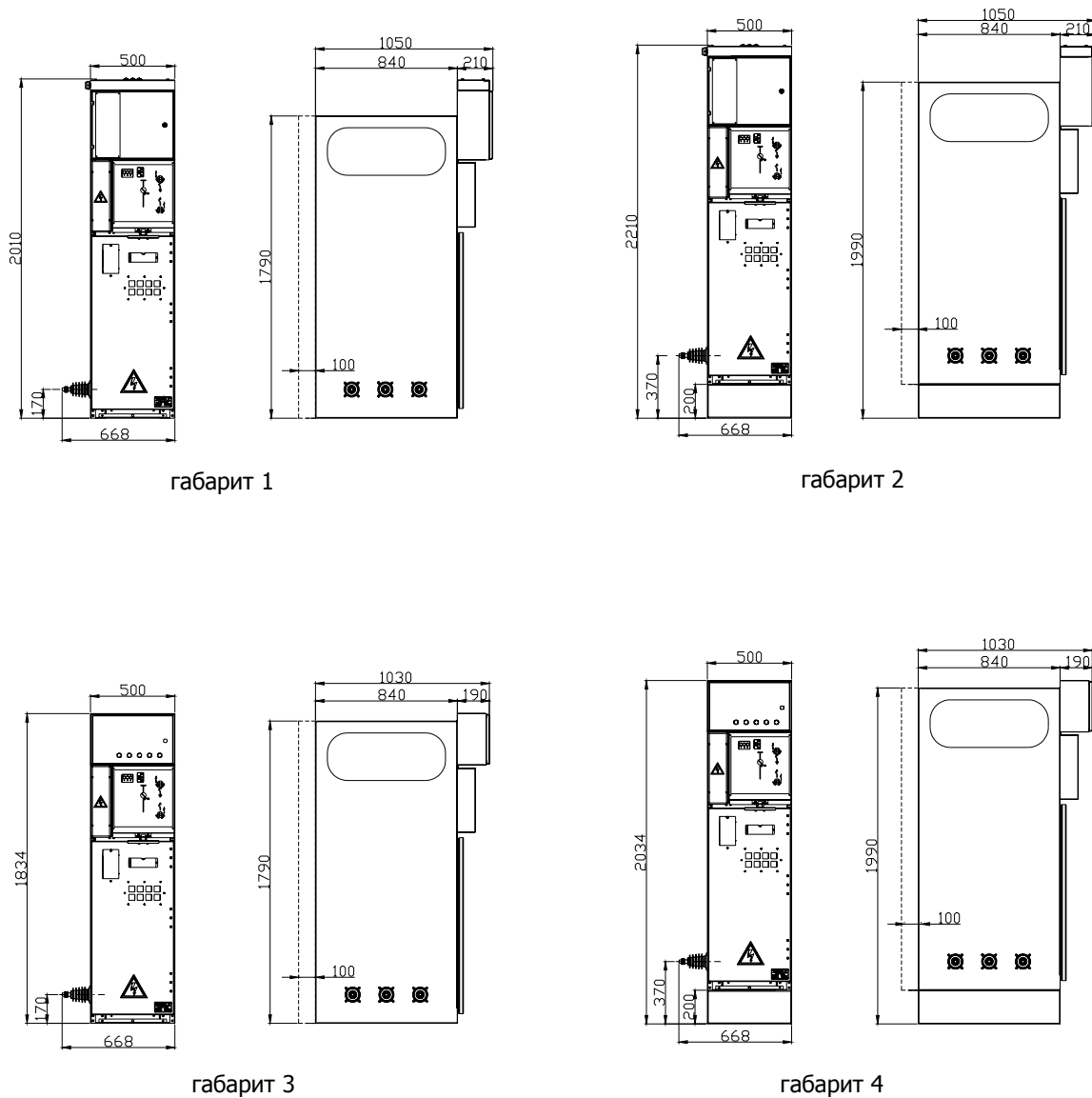
Рис. 3. Габаритные размеры КСО с шириной корпуса 500 мм (схемы №№ 1, 3.1, 6, 7, 7.1, 12, 16, 17, 20.1, 20.2, 23, 24, 24.1, 24.2, 30, 30.1, 30.2, 36, 37, 39, 40, 40.1, 41).
