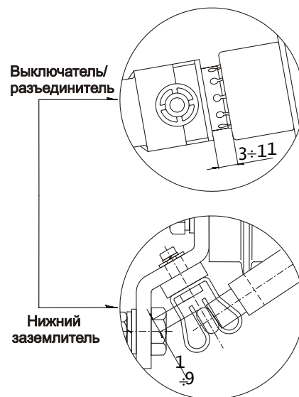
Рис. Д.4 Проверка правильности регулировки тяг заземлителей.
