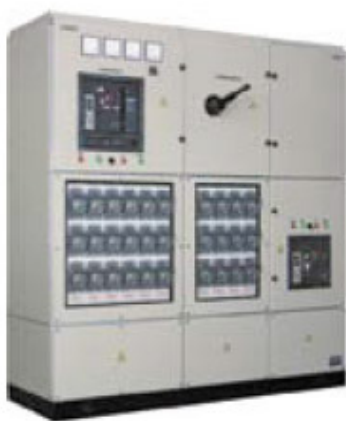
Рис. 25. ЩО-2000, 1 секция, 10 отходящих присоединений с защитой предохранителями, 1 отходящая линия с защитой автоматическим выключателем
