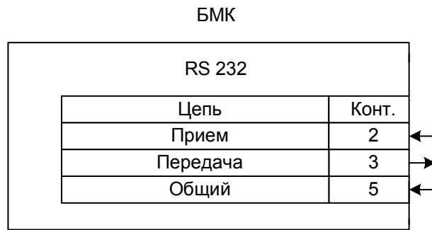
Рис. 8.7. Схема электрическая подключения к порту RS232
